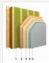
zateplení dřevostaveb (foukaná izolace, dřevovláknem)
